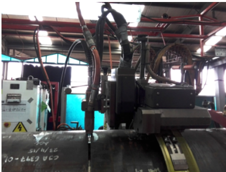
图 1 全自动焊设备 Fig. 1 Automatic welding equipment
