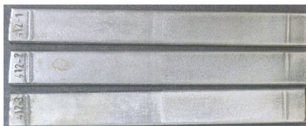
图6 试样清洗后宏观检测
